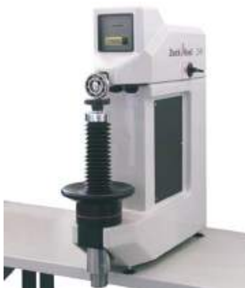
Figura 6 - Durómetro para ensaio de dureza Rockwell.
